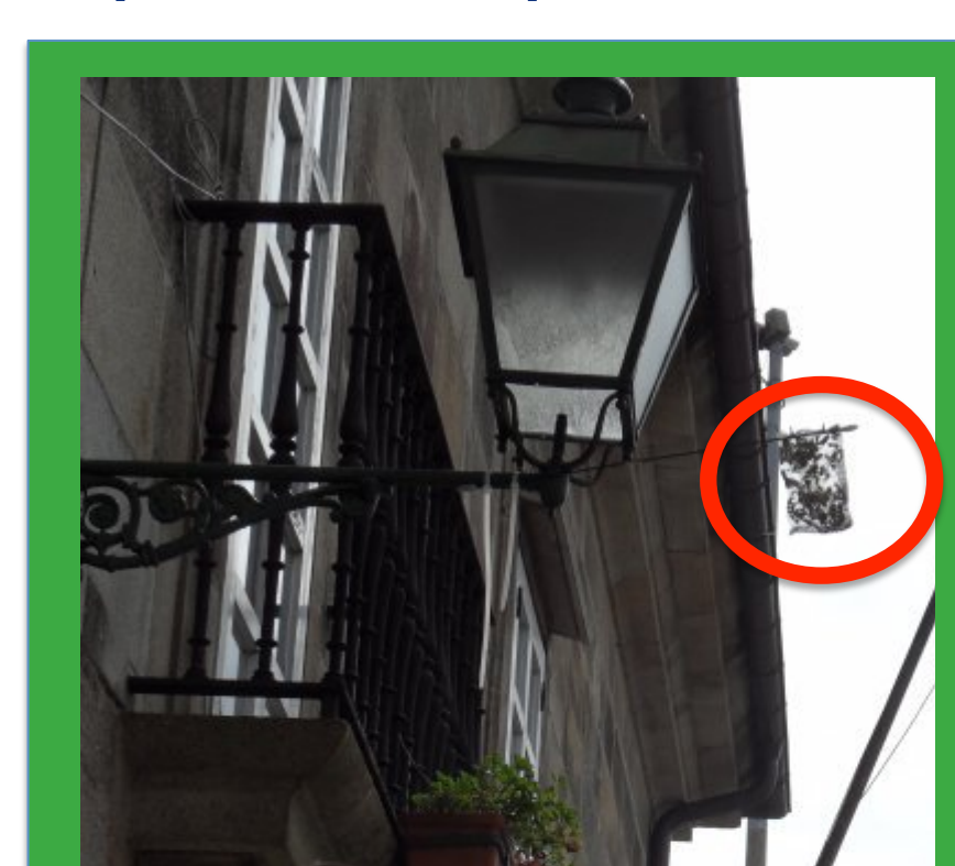
Figura 3.- Sistema de sujeción del briocaptador en una farola
